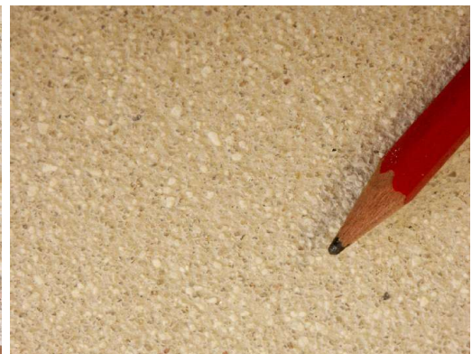
Mortier d'enduit prêt à l'emploi, constitué de grain trop fin, trié, et une quantité de liant trop importante...
