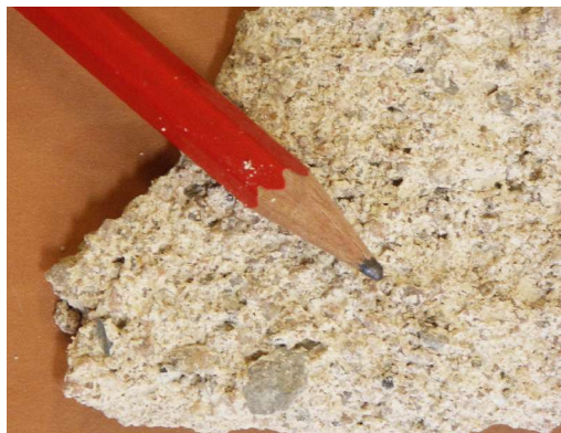
Mortier d'enduit de la fin du 18ème: les grains sont très variés (jusqu'à 10mm)
